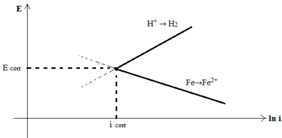
Рисунок 3.2.1 – Диаграмма Эванса, позволяющая определить ток и смешанный потенциал коррозии (железо в кислом растворе). Прямые получены тафелевской аппроксимацией (высокие перенапряжения)
